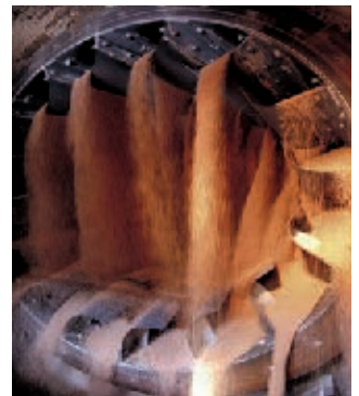
Photos ci-dessus : À gauche : contrôle de qualité à l'usine EuroChem Anvers À droite : production de Nitrophoska® (tambour de granulation)
